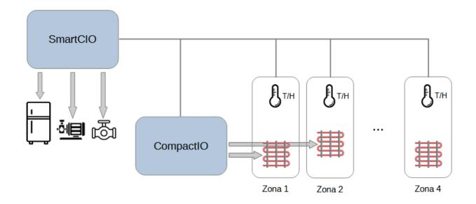
Con questa tipologia di installazione si controlla l'umidità e il radiante di ogni zona in caldo e freddo tramite un **relè della scheda CompactiO**. Le misure di temperatura e umidità dell'ambiente sono fornite dalle sonde T/H.
