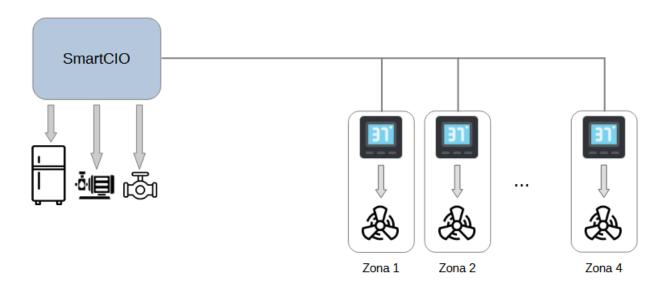
Con questa tipologia di installazione si controlla il fan coil di ogni zona in caldo e freddo tramite i **relè a bordo del terminale** ROOM/MINI-TOUCH che fornisce anche la misura di temperatura dell'ambiente.
