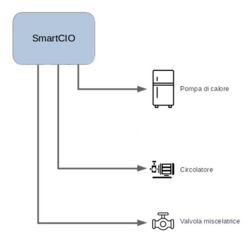
In questo scenario l'accensione della pompa di calore e del circolatore non può essere controllata dalle chiamate delle zone, che non sono presenti. E' invece controllata da una programmazione oraria che può essere impostata tramite app "Termogea".
